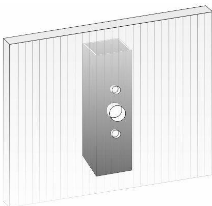
Рис № 4. Подготовка отверстий.
