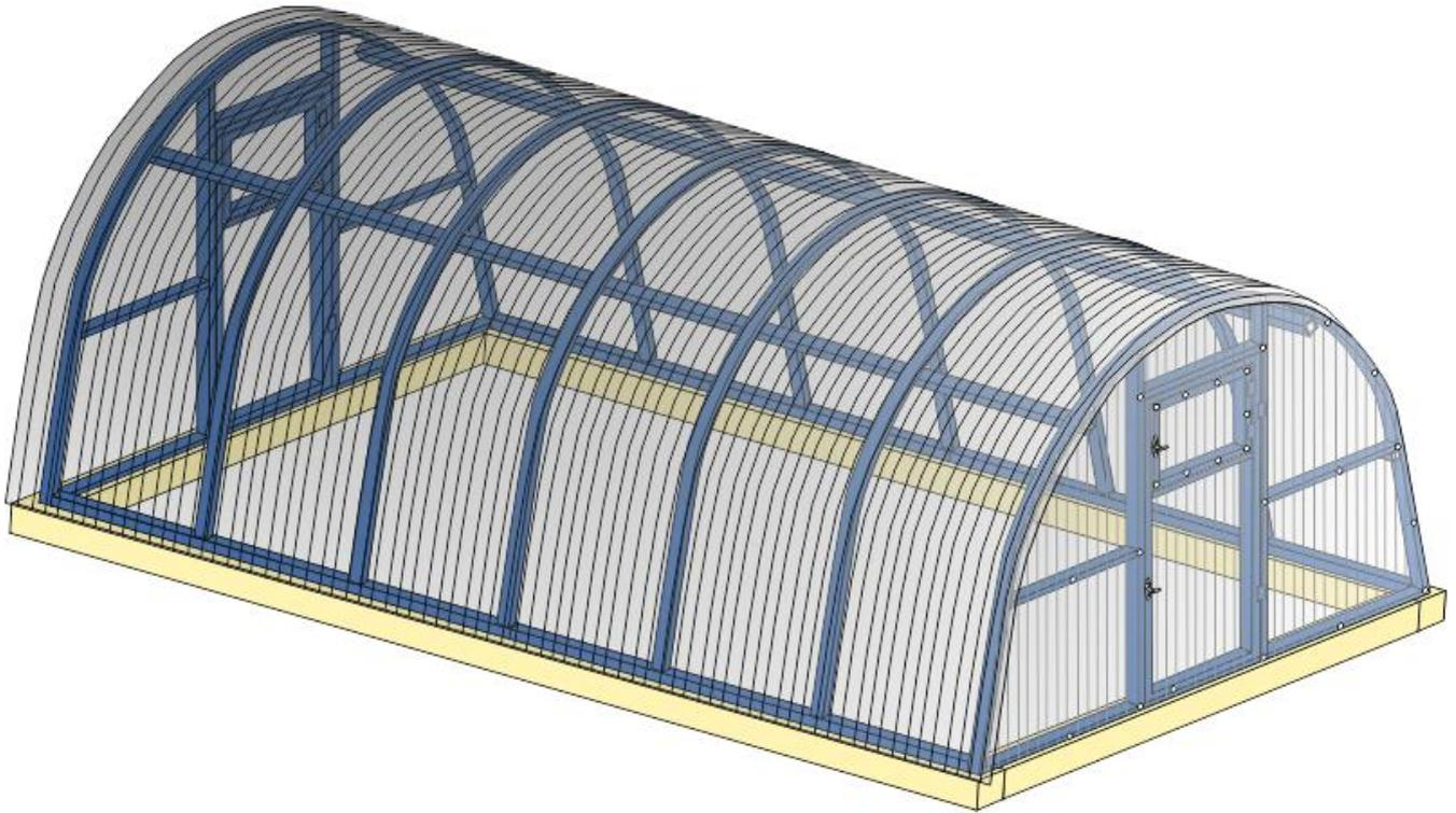
Рис № 14. Покрытие поликарбонатом верхней части теплицы.
