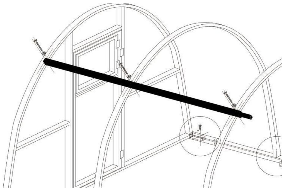
Рис № 12. Соединение с помощью продольных стяжек.
