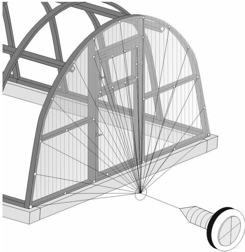
Рис № 3. Точки крепления саморезов на торцах теплицы.
