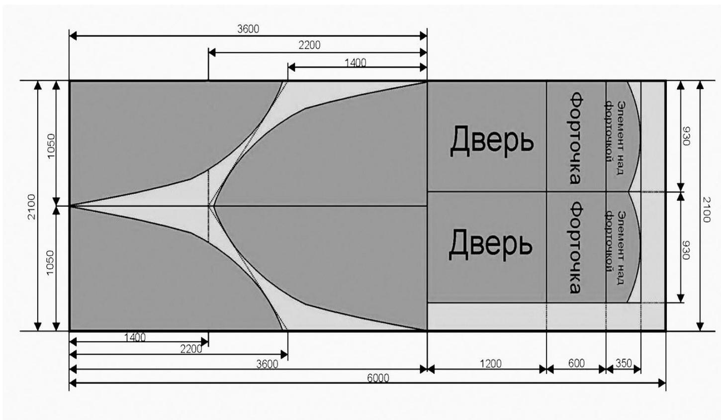
Рис № 2. Схема раскроя поликарбоната.
