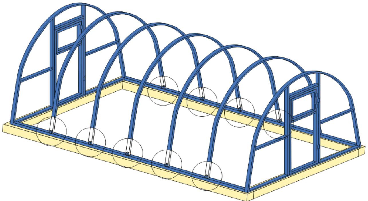
Рис № 11. Установка дуг.
