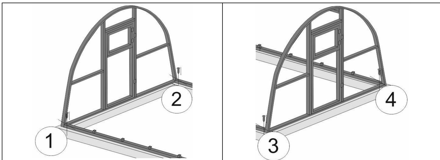
Рис № 11. Места стыковки соединяем саморезами (позиции № 1, 2, 3, 4).
