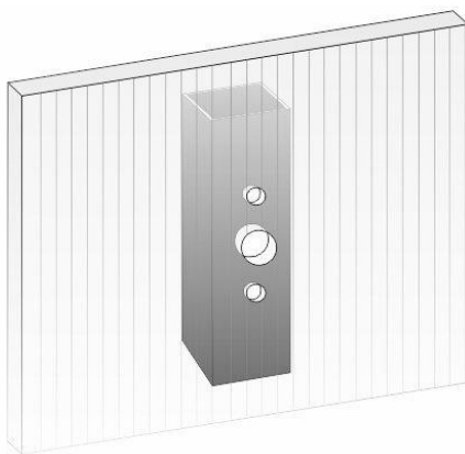
Рис № 4. Подготовка отверстий.
