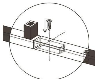
Рис № 9. Схема крепления саморезом.
