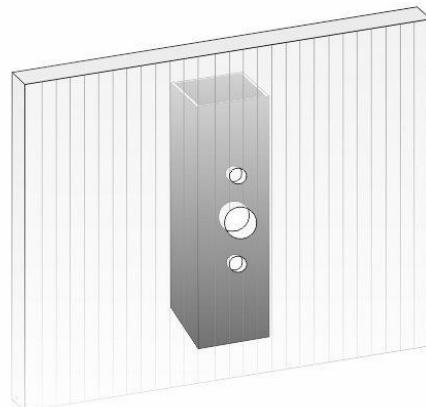
Рис № 4. Подготовка отверстий.
