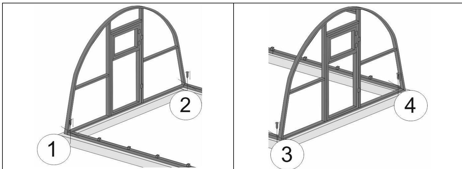
Рис № 11. Местастыковки соединяют саморезами (позиции № 1, 2, 3, 4).
