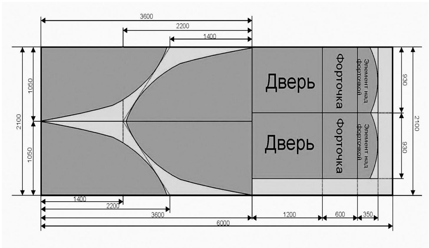
Рис № 2. Схема раскроя поликарбоната.
