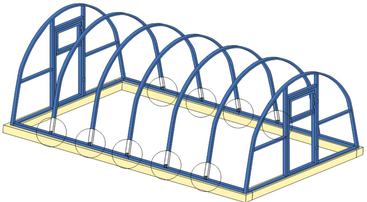
Рис № 11. Установка дуг.
