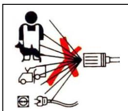
Внимание! Высоконапорные струи воды представляют потенциальную опасность при некорректном использовании. В частности, не направляйте струю воды на людей или животных, электрическое оборудование или на сам агрегат. Будьте осторожны!
