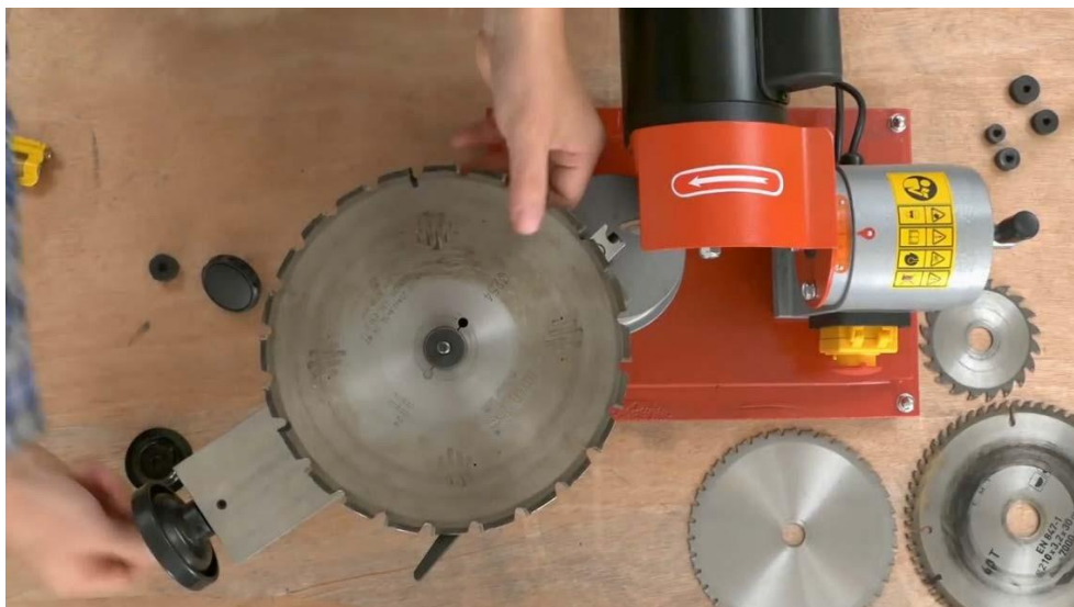
Рис 21.2 Маховиком (8), установите диск в рабочее положение. Зафиксируйте положение винтом (5)
