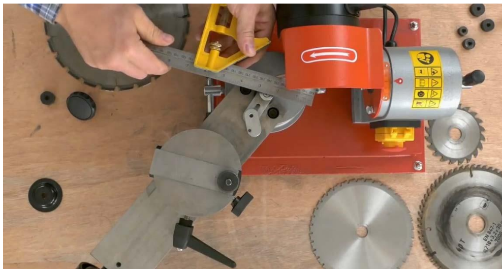
Рис 22 4 Ползун должен быть параллелен конусной стороне диска. Зафиксируете данное положение винтом ползуна (6)
