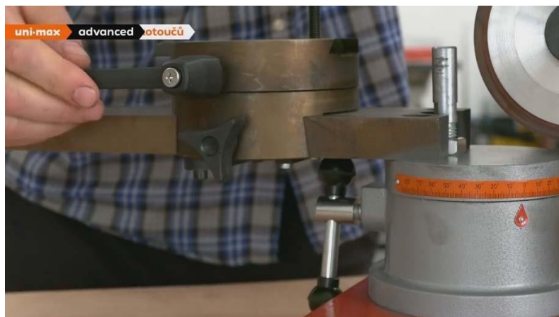
Рис. 12.3 Ослабьте винт (6) Винт суппорта
