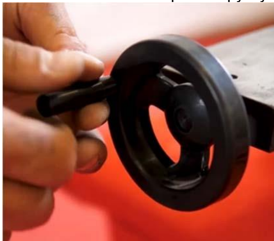
Рис. 4.3. Установите и закрутите ручку в маховик
