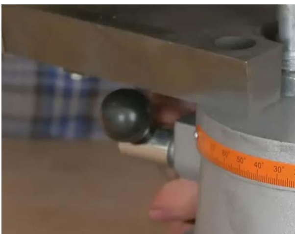
Рис. 16.2 Винт фиксации суппорта (3)
