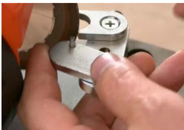
Рис. 9.1 Установите шаблон (16), чтобы заточить все зубья в одинаковой степени
