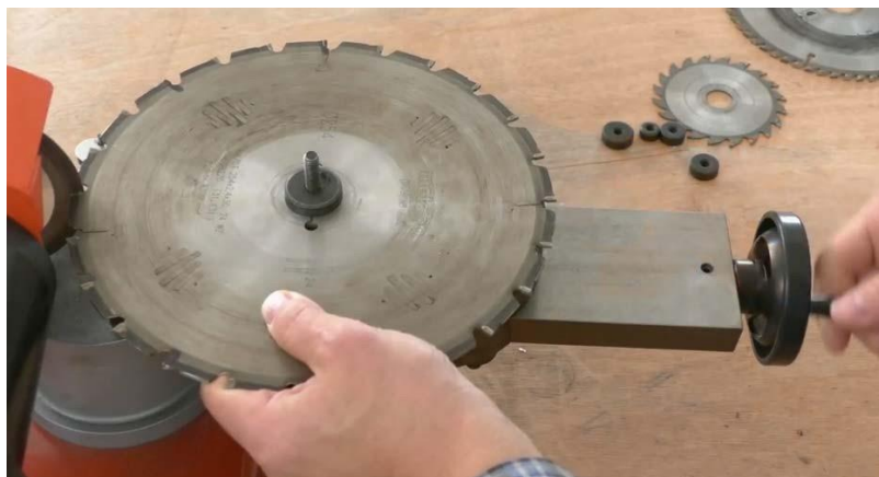
Рис. 13.1 Маховиком (8), установите диск в рабочее положение
