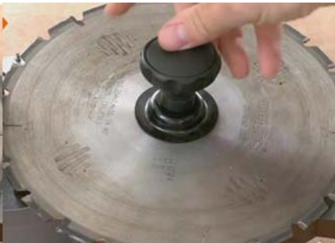
Рис. 15.4 Зафиксируйте пильный диск ручкой винтом (12)
