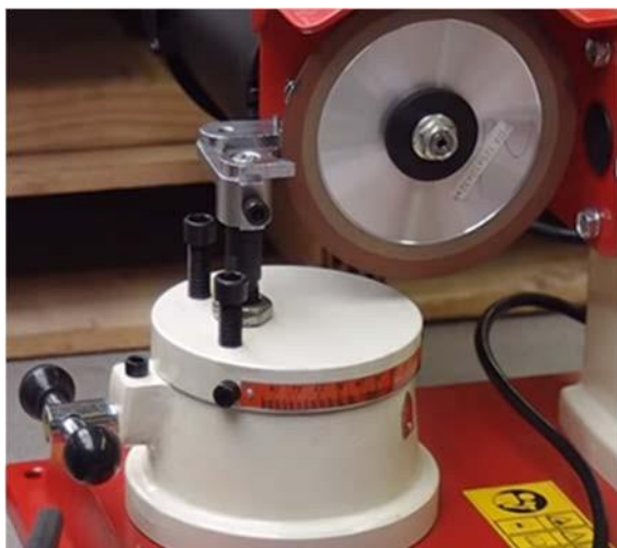
Рис. 3.1. Виты фиксации опоре суппорта
