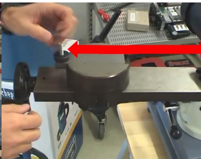
Рис. 6.2. Положение 2 при заточке пильных максимальных диаметров дисков. Стрелкой указан радиус затачиваемого диска
