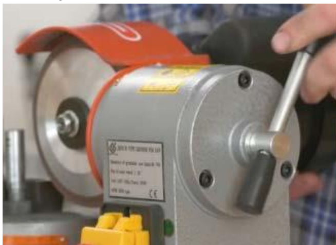
Рис. 11.1 Ослабьте крепеж винта (18)
