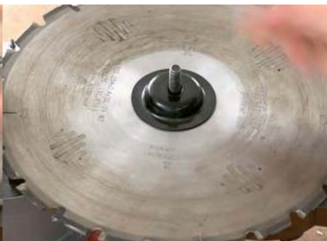
Рис. 15.2 Установите прижимную пластину (11)
