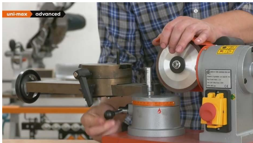
Рис. 12.1 Ослабьте винт (3) Винт фиксации стойки суппорта
