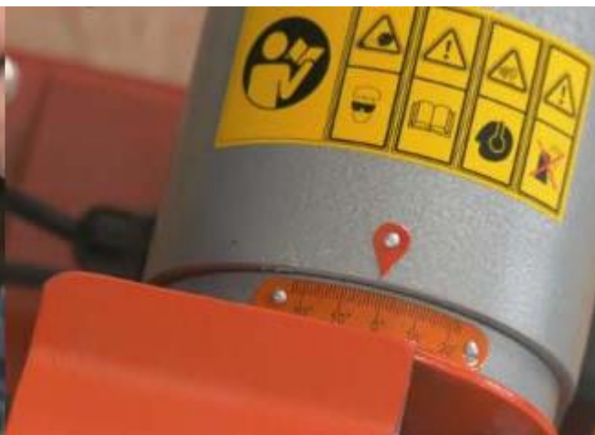
Рис. 11.2 Установите угол наклона 0 град
