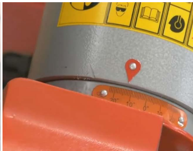
Рис. 20.2 Установите угол наклона
