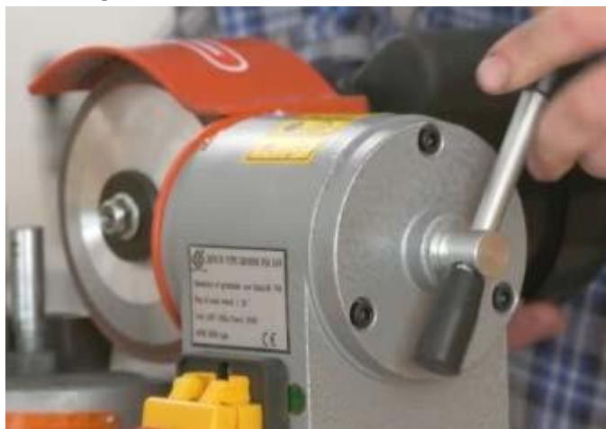
Рис. 20.1 Ослабьте крепеж винта (18)
