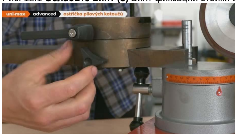
Рис. 12.2 Ослабьте винт (5) Винт фиксации положения ползуна
