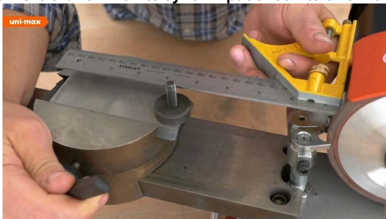
Рис. 14.1 Установите ползунок параллельно плоскости шлифовального круга Зафиксируйте винтом (6)
