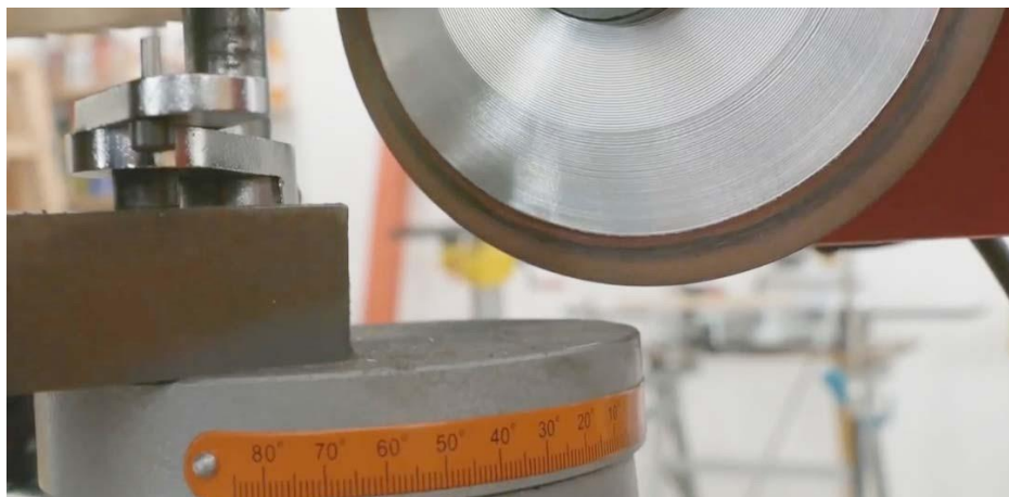
Рис 22 5 Вы можете записать значение чтобы настраивать станок для заточки этого диска быстрее в следующий раз
