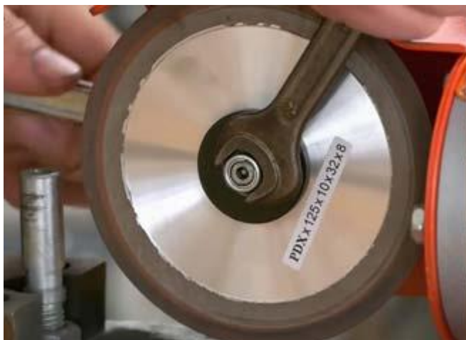
Рис. 8.1 Снять зажимную гайку
