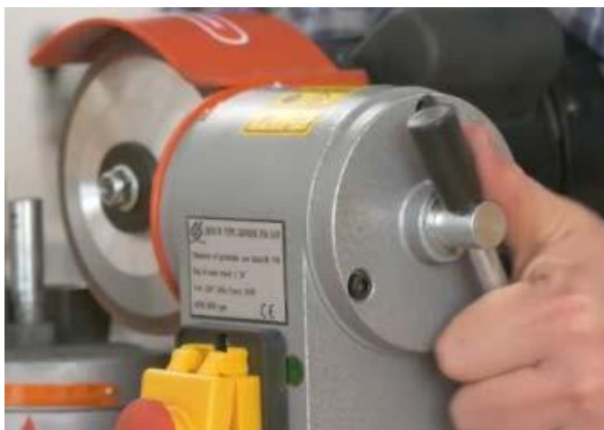
Рис. 20.3 Винтом (18) зафиксируйте положение
