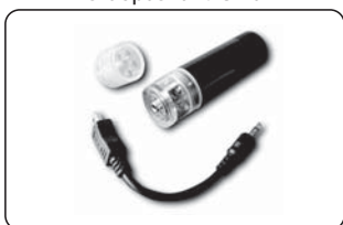
Экстренное з/у, на 1 батарее AA, с фонариком с 5 светодиодами
