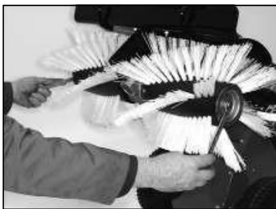
Теперь закрепите щетки контргайкой. (Придерживайте гайку на другом конце оси другим гаечным ключом)
