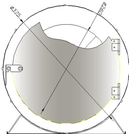
полки, на которые укладываются прокаливаемые электроды. Рабочая камера нагревается трубчатым электронагревателем мощностью 0,75 кВт, расположенным внутри камеры в нижней ее части. В верхней части рабочей камеры установлен патрубок для дренирования рабочего пространства. На лицевой панели пульта управления расположена ручка реле-регулятора и световая индикация нагрева.
