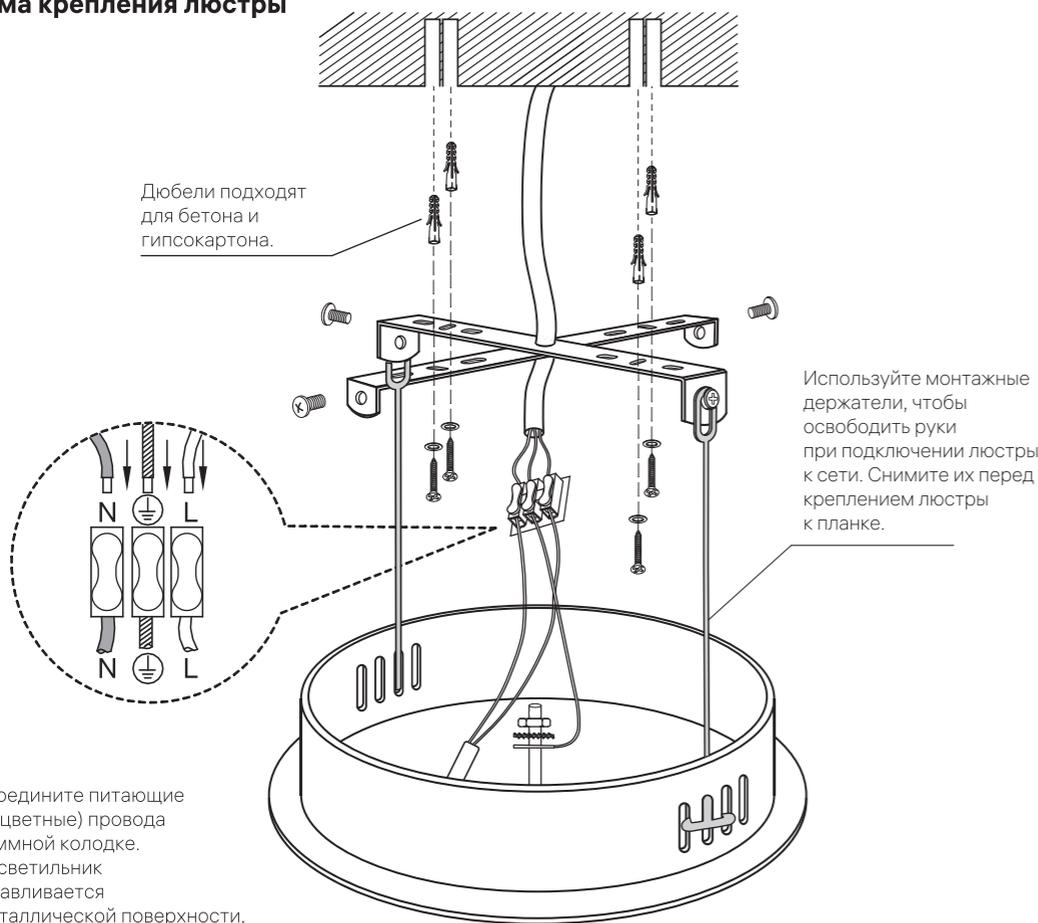
Подсоедините питающие (одноцветные) провода к клеммной колодке. Если светильник устанавливается на металлической поверхности, поверхность должна быть заземлена.
