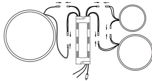
1. Схема подключения элементов плафона
