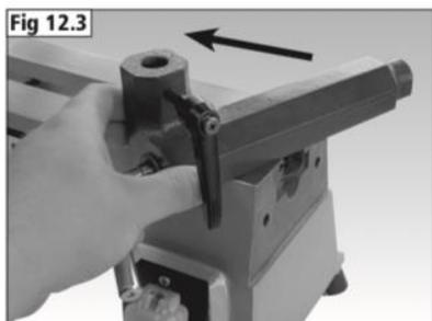
Теперь полиамидную стопорную гайку можно отрегулировать таким образом, чтобы резцедержатель прочно удерживался на станине станка, если ручка кулачка затянута, а также чтобы он мог свободно перемещаться по всей длине, если ручка ослаблена, Рис. 12.4.
