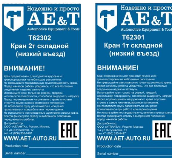
Рис. 2. Табличка с паспортными данными.
