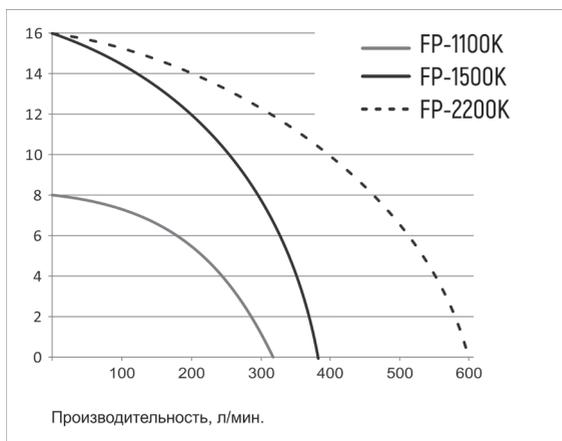
*Производительность насоса напрямую зависит от напора (высоты подъема воды). Не рекомендуется использовать насос при максимальном напоре – в этом случае подача воды будет минимальна;*
