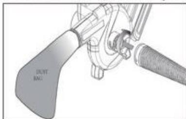
1. При удалении пыли установите мешок для пыли на отверстие для струйной очистки и сопло на отверстие для всасывания.
