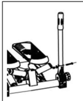
Подсоедините срединную трубку поручня к нижней части тренажера и закрепите ее при помощи болта (№32), плоской шайбы (№33) и гайки (№34), как показано на рисунке.
