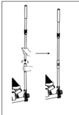
Вставьте верхнюю часть поручня в нижнюю трубку, прокручивая ее по часовой стрелке, после чего зафиксируйте конструкцию. Таким же образом закрепите второй поручень. При необходимости отрегулируйте высоту поручней с помощью соответствующей ручки (№41).
