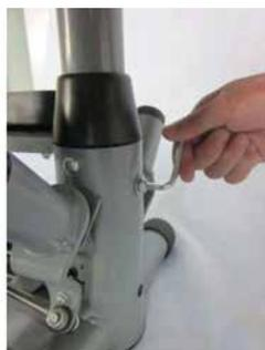
4. Вставьте нижнюю трубку (№5) в основание (№1), закрепите с помощью 4 дуговых шайб (№49) и 4 винтов M8x25 (№43). Зафиксируйте шестигранным ключом (№ 52).
