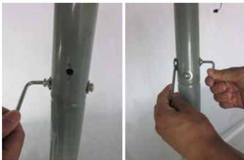
7. Прикрепите верхнюю трубку (№ 4) к нижней трубке (№5) с помощью дуговых шайб (№49) и 2 винтов М8х25 (№43), гайки М8 (№ 47) и 1 болта (№8). Зафиксируйте шестигранным ключом (№52) и гаечным ключом (№53).
