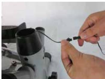
3. Подключите провод электронного дисплея (№44) к проводу из основания (№ 1). Этот провод (№44) проходит через нижнюю трубку (№5).
