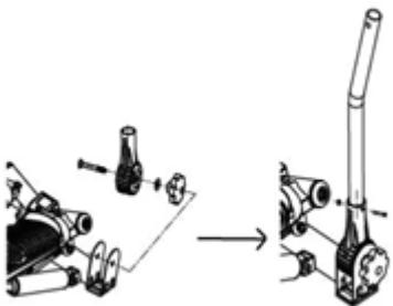
2. Прикрепите фиксатор поручней к передней трубке, закрепите ручкой. Вставьте нижнюю часть поручня в фиксатор и закрепите винтом и гайкой.
