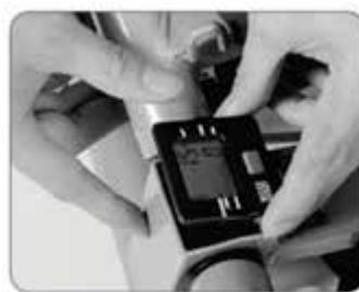
Установите консоль на место и проверьте ее функциональность. ВАЖНО: Извлечение батареек будет стирать любые сохраненные данные. Если параметры на мониторе отображаются неправильно, пожалуйста, удалите и заново установите батарейку, для получения корректного результата.
