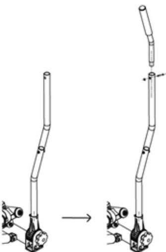
4. Соедините среднюю и верхнюю часть поручня, закрепите их, как показано на рисунке. Повторите это действие для сборки второго поручня.
