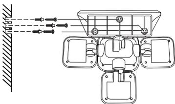
Закрепите светильник с помощью монтажного комплекта.
