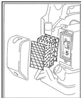
Загрязненный воздушный фильтр снижает мощность двигателя, увеличивает расход топлива и затрудняет запуск.
