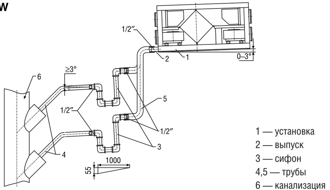
Для отвода конденсата в систему канализации необходимо предусмотреть дренажную трассу с сифоном. Уклон труб должен быть не менее  $3^\circ$  (0,55 на 1 м). Перед запуском установки дренажная трасса должна быть испытана, а сифон заполнен водой. Если температура в помещении, где установлен агрегат, ниже  $0^\circ$ , то система отвода дренажа должна быть теплоизолирована надлежащим образом.
