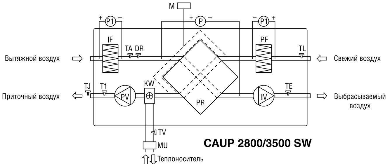
PV — вентилятор приточного воздуха.
