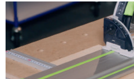
Подвижной упор КТ MV свободно перемещается в верхнем пазу профиля-упора КТ ЕМ
