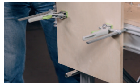
Для крепления тяжелых больших заготовок на боковой поверхности стола используйте опору-втулку KT SU
