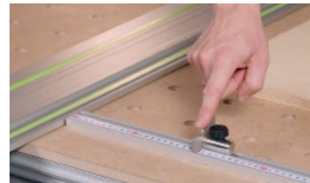
Подвижной упор КТ MV свободно перемещается в верхнем пазу профиля-упора КТ ЕМ
