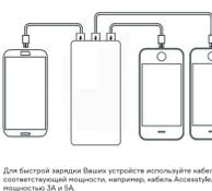
Для быстрой зарядки Вашего устройства используйте кабель соответствующей марки, например, кабель AccessStyle, мощностью 3A или 5A.
