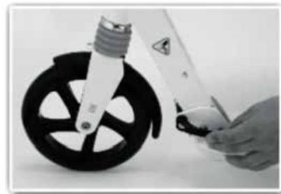
Оттяните вверх или в сторону рычаг для складывания, чтобы разблокировать механизм складывания. Поднимите вверх рулевую колонку самоката до характерного щелчка и зафиксируйте ее с помощью этого же рычага для складывания. Если в модели имеется специальный зажим, зафиксируйте стойку с его помощью.
