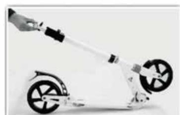
Откройте механизм на рулевой колонке и нажмите фиксирующий рычаг вперед, чтобы разблокировать механизм складывания.
