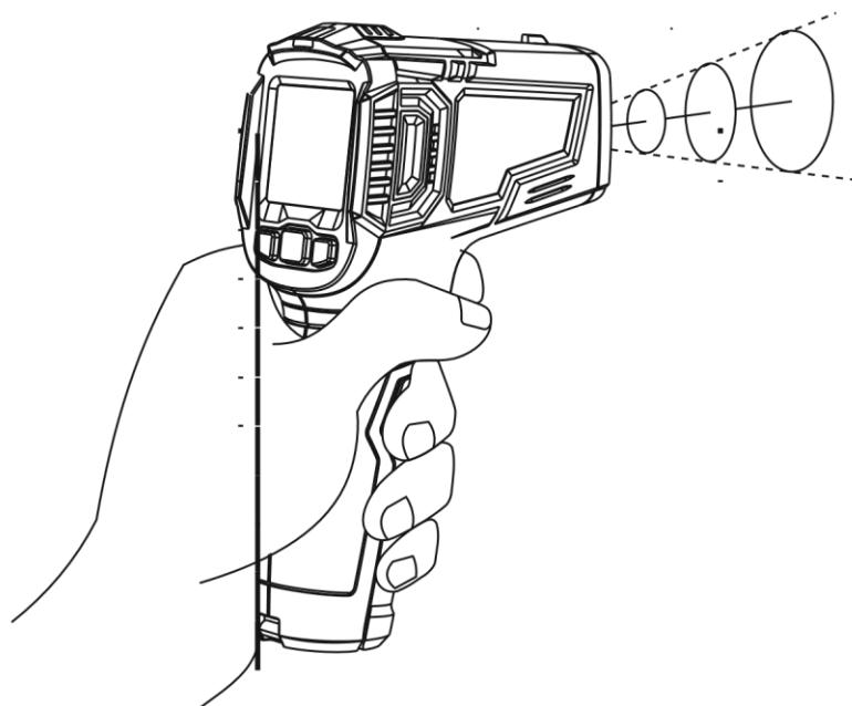
Максимальное значение прибора показывает максимальное значение измеряемой температуры. Индикатор тревоги прибора горит красным, когда измеренное значение превышает установленное значение сигнала тревоги верхнего предела температуры или измеренное значение меньше установленного значения сигнала тревоги нижнего предела температуры.
