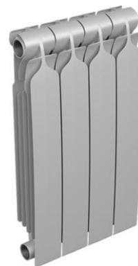
Секции радиатора выполнены из трубчатого сварного каркаса из высококачественной стали, залитой снаружи алюминиевым сплавом под высоким давлением. Сборка секций осуществляется с использованием усиленных стальных ниппелей и прокладок типа «O-ring» из термостойкого силикона. Данная конструкция радиатора позволяет полностью исключить контакт теплоносителя алюминиевым сплавом и обеспечивает эффективную теплоотдачу при максимальной прочности и коррозионной стойкости.
