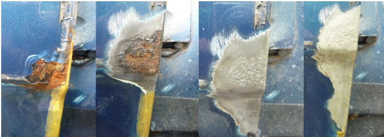
Исходная часть автомобиля поврежденная коррозией
