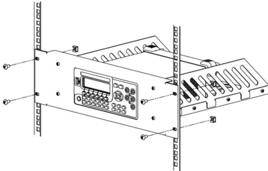
7. Примечание после установки: корзина имеет высоту 3U, отверстия для установки корзины указаны стрелочкой, обратите внимание на их выравнивание при установке.
