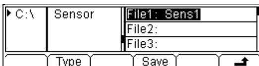
Нажмите клавишу **↩**, вернитесь в **Пользовательский** интерфейс произвольного датчика.
