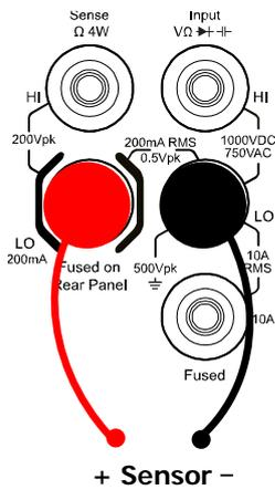
Измерение произвольного датчика
