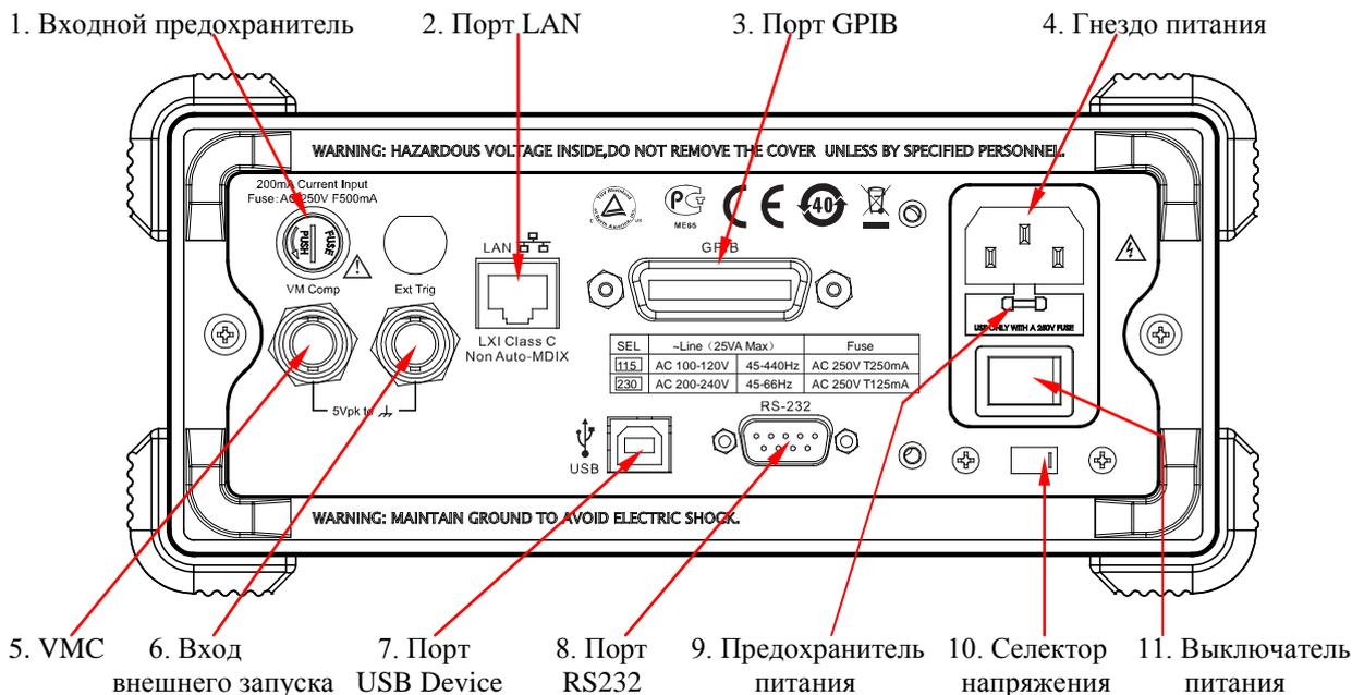
Рис. 1-6 Схема задней панели DM3068
