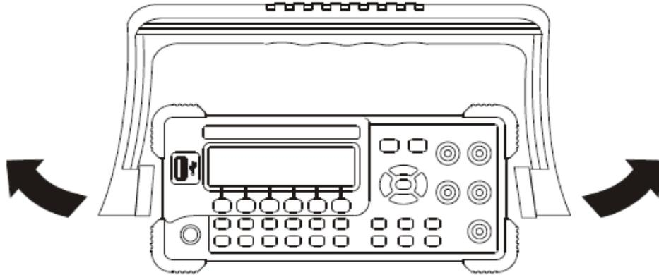
Рис. 1-1 Регулировка ручки
