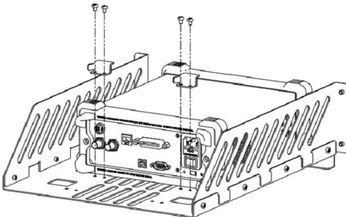
5. Установите переднюю панель: совместите отверстия передней панели с лицевой частью прибора, зафиксируйте с помощью четырех винтов М4.
