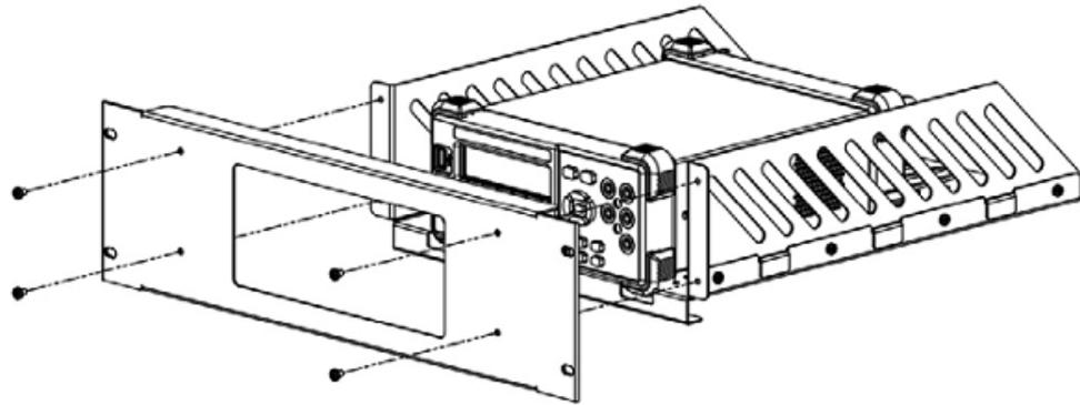
6. Поместите в шкаф: с помощью четырех винтов М6 и четырех квадратных гаек М6 закрепите корзину прибора и установите его в стандартный 19-дюймовый шкаф.
