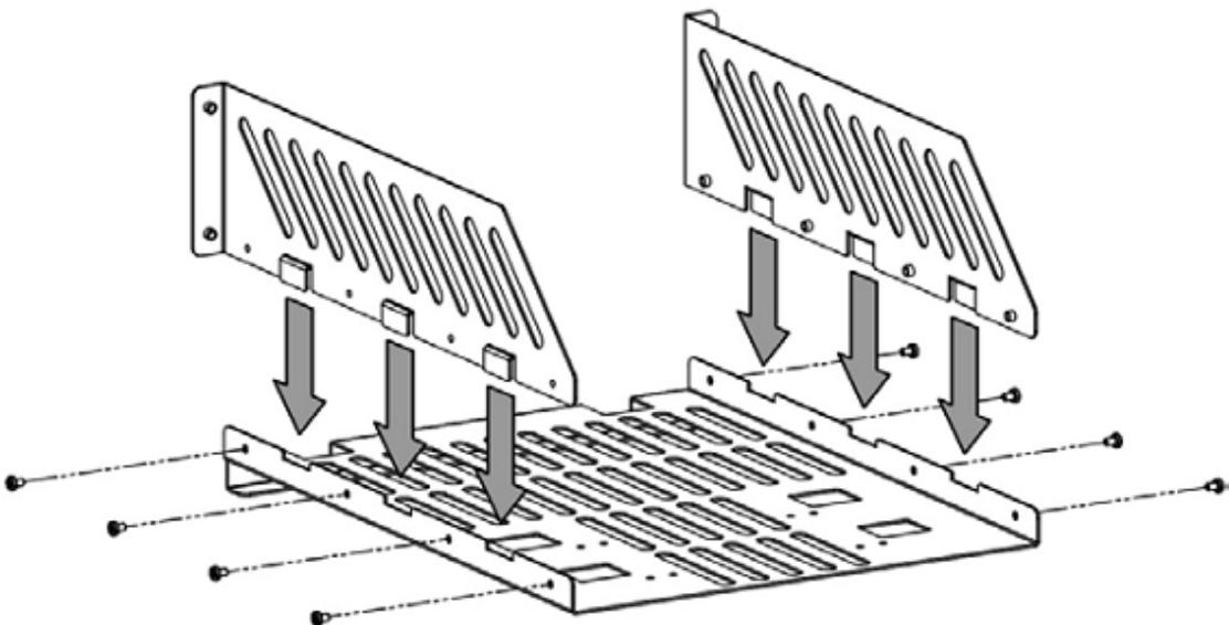
3. Установите прибор: ножки прибора направьте в соответствующие отверстия и положите его на опорную панель.
