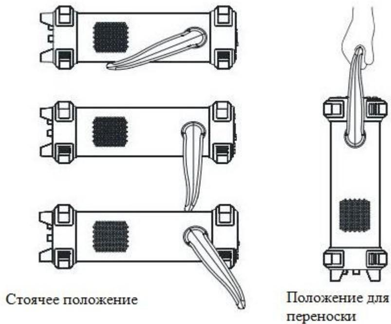
Рис. 1-2 Постановка прибора
