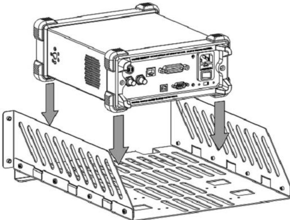
4. Зафиксируйте прибор: двумя прижимными лапками прикрепите прибор к опорной панели, зафиксируйте с помощью четырех винтов М4.
