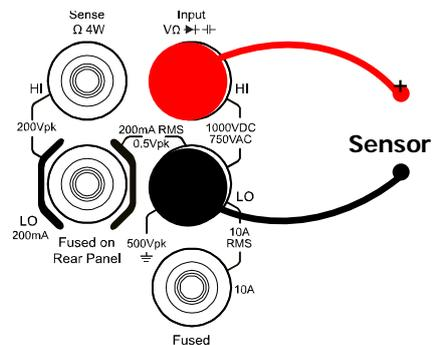
Измерение произвольного датчика
