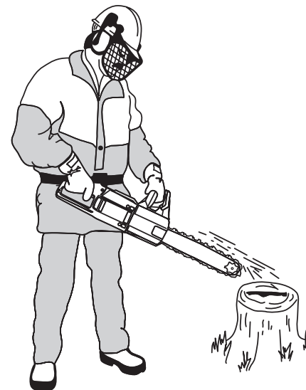
Рисунок 7 — Контроль устройства автоматической смазки режущей гарнитуры
