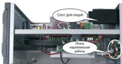
Схема установки платы параллельной работы
