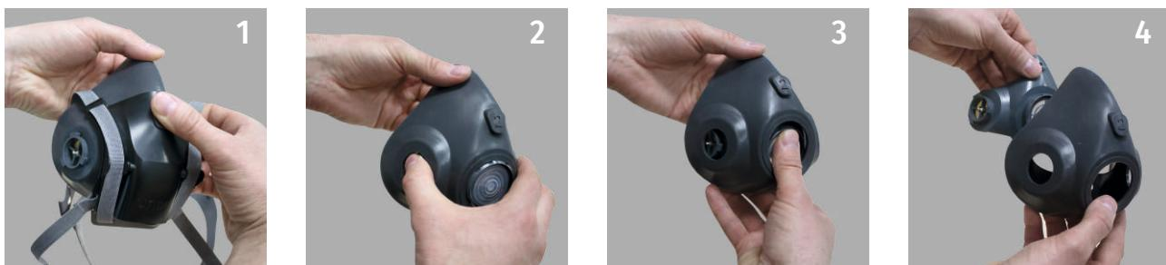
1. Снимите защитный экран с оголовьем и шейной тесьмой: возьмите в одну руку полумаску, большим пальцем другой руки нажмите на выступ с обозначением роста, два пальца заведите между корпусом и защитным экраном, отсоедините экран от корпуса.
