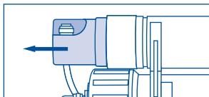
При помощи вильчатого пластикового ключа отсоедините фитинги от корпуса фильтроэлемента.
