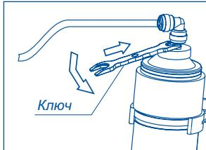
Для предотвращения растекания воды при демонтаже установите на пластиковые трубы фильтроэлемента транспортные заглушки. Придерживая водоочиститель, снимите отработанный фильтроэлемент с клипс. Запомните направление потока воды, указанное на наклейке фильтроэлемента.
