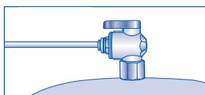
Откройте кран для чистой воды, чтобы сбросить давление, затем закройте кран.
