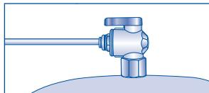
Откройте кран для чистой воды, чтобы сбросить давление, затем закройте кран.
