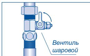
Для исполнения БАРЬЕР ПРОФИ Осмо Boost отключите электропитание повышающего насоса. Закройте кран накопительной ёмкости.
