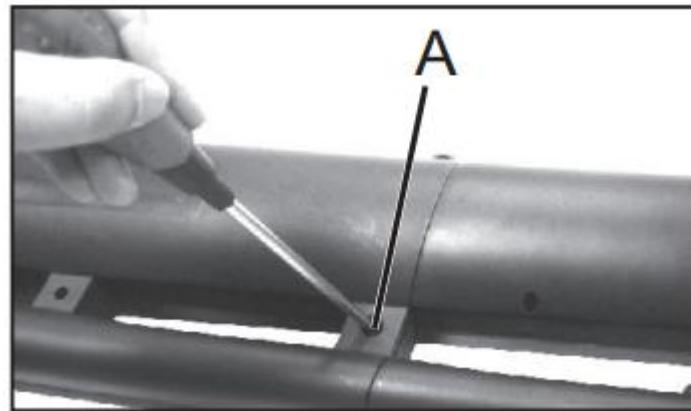
Соедините две части всасывающей трубы.
