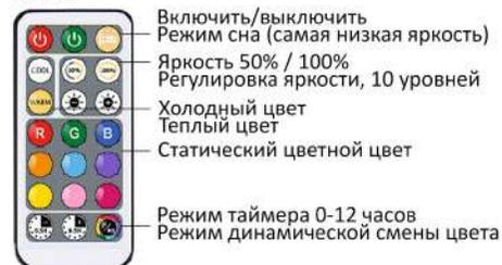
При каждом нажатии на кнопки установки таймера ночник будет мигать, а таймер увеличиваться или уменьшаться на 30 минут. При достижении таймера 0 минут или 12 часов ночник моргнет дважды.
