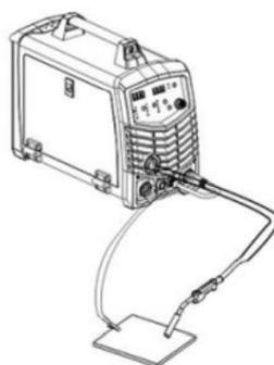
**Подключение безгазового сварочного пистолета**
