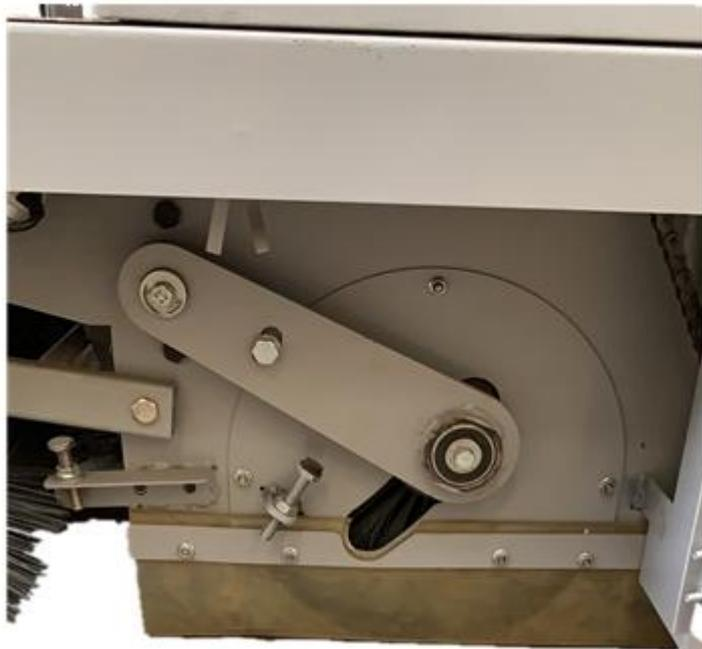
Когда будет необходимо заменить или почистить основную щетку, откройте левую дверцу, открутите фиксирующий болт и вытащите соединительную плату; затем открутите две фиксирующие гайки дефлектора основной щетки и вытащите его. Теперь основную щетку можно вытащить для обслуживания. После чего установите ее на место в обратном порядке.
