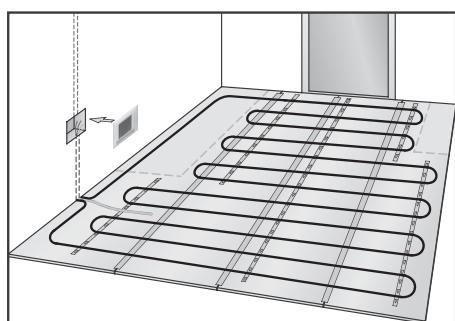
По завершении укладки следует измерить электрическое сопротивление между коричневым и синим проводами нагревательной секции, его значение должно соответствовать указанному в инструкции.
