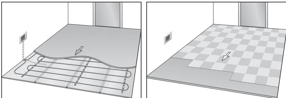
раствора толщиной 2-3 сантиметра. Бетон не должен содержать острых камней, его консистенция должна обеспечивать полную заливку кабеля без образования воздушных карманов.
