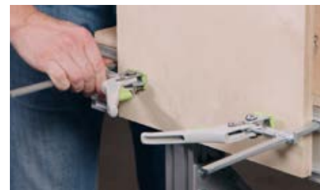
Установите струбцины в боковые пазы стола, зафиксируйте и обрабатывайте торец заготовки
