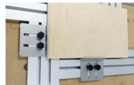
Выравнивание заготовки на фрезерных шаблонах с помощью упоров KT RJS
