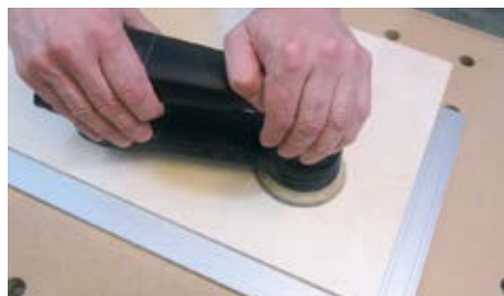
Крепления заготовки с помощью верстачных упоров КТ PS
