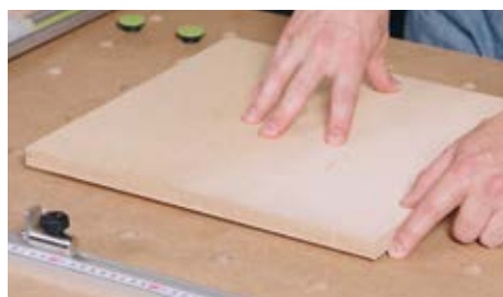
Протекторы приподнимают заготовку над столешницей
