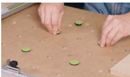
Установите протекторы в отверстия столешницы
