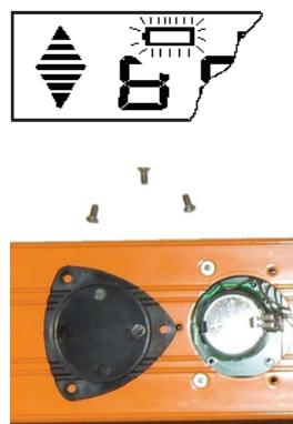
**ВАЖНО!** Если на дисплее отображается сообщение “error” то немедленно замените батарею (CR 2032) на обратной стороне прибора. Эта батарейка обеспечивает питание, когда батареи не работают, для сохранения всех калибровок в памяти прибора. Перед заменой батареи (CR 2032) выключите прибор.
