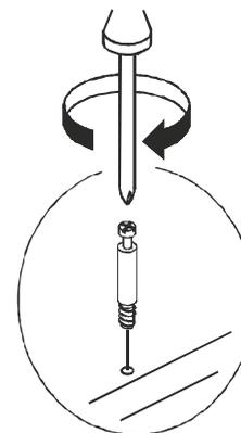
Рис.2 Установка и фиксация стяжки эксцентрика
