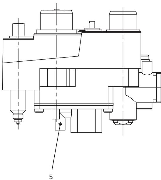
1 - кнопка магнитного клапана; 2 - рукоятка терморегулятора; 3 - кнопка пьезорозжига; 4 - винт регулятора давления газа; 5 - штуцер выходного давления
