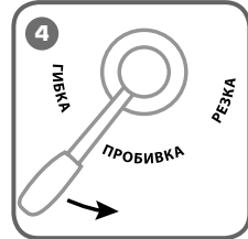
Установите рычаг распределительного крана в соответствии с проводимым видом работы
