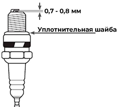
3. Проверьте свечу зажигания, если электроды изношены или повреждена изоляция, замените свечу.
