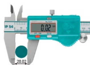
Измерение дифференциальным методом (применение установки нуля)
