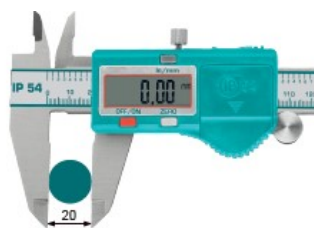
Измерение дифференциальным методом (применение установки нуля)
