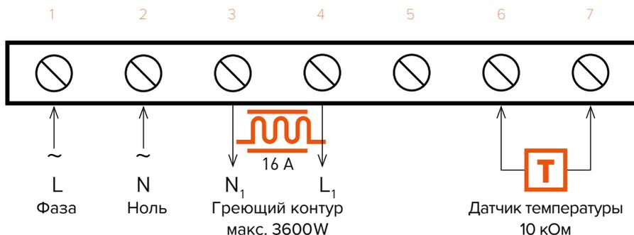
Подключите систему теплого пола к терморегулятору CLIMATIQ BT; PT после полного высыхания плиточного клея в соответствии с рекомендациями производителя. Начертите схематично места установки кабеля, воспользовавшись приложением на стр.13 и зарегистрируйте систему. Процесс регистрации описан в Гарантийном талоне на стр. 15.
