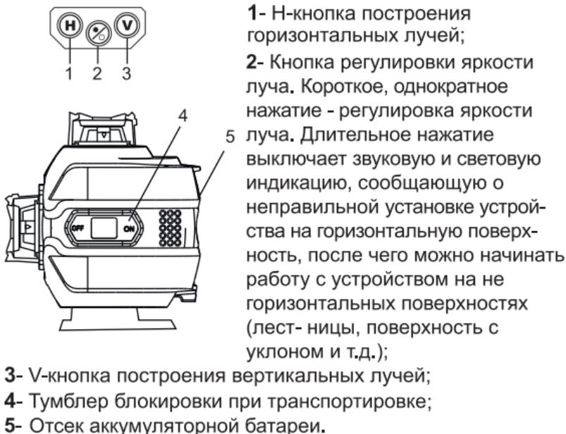
**При включении устройства снимите блокировку. При транспортировке устройства, обязательно установите переключатель в режим блокировки устройства, во избежание его поломки в процессе транспортировки.**
