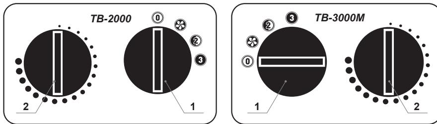
Рис. 1. Блок управления: 1 – переключатель режимов; 2 – терморегулятор
