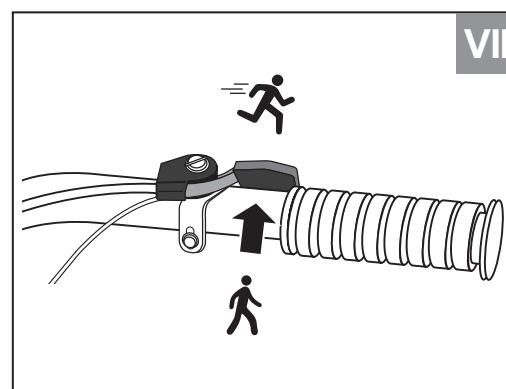
11. Сцепление и регулировка
