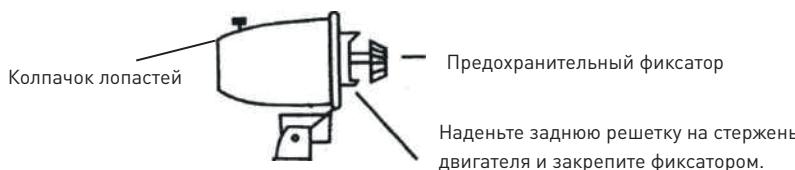
Закрутите колпачок на стержне, поворачивая против часовой стрелки.
